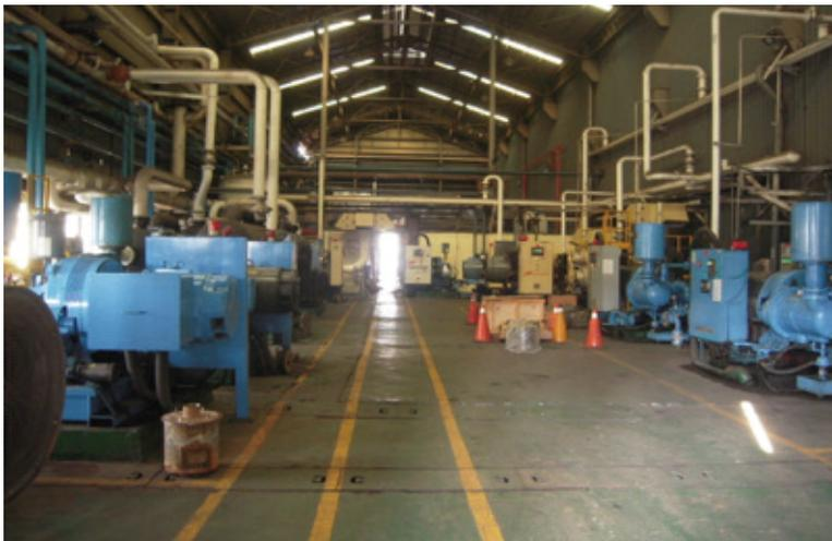
針對空壓系統之改善，在產線設有監控系統，運用人員管理的方式，定時派理人員現場巡檢，是否有洩漏狀況，並就產線停機狀況，決定是否關閉機台。
