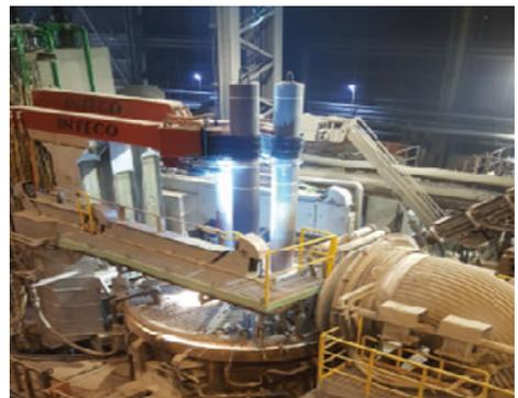
35噸電弧爐送電中照片
