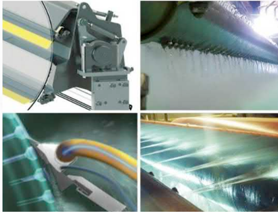
▲ 高效脫水，刮刀和整體清潔度優化示意圖
