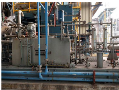
由左至右：K-6605 壓能發電機、尾氣壓能回收系統、新增膨脹透平機推動發電
