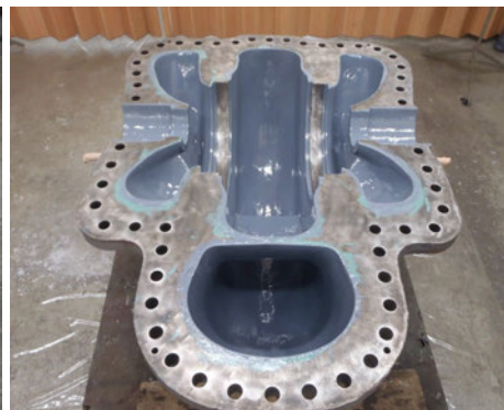
由左至右：鍾副總廠長說明冷卻水循環泵浦的陶瓷複合材防蝕工程、改善前的冷卻水泵浦、改善後的冷卻水泵浦
