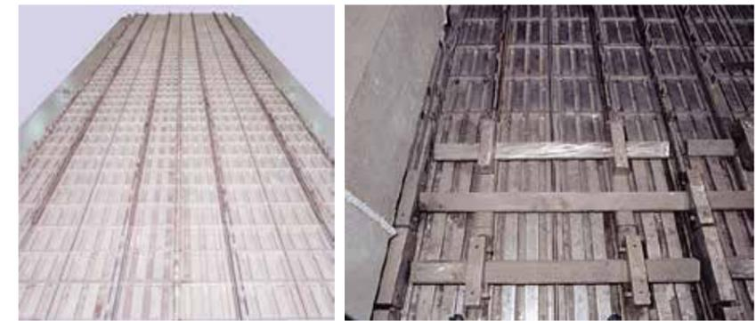
圖 2.4-12 固定式吹氣爐排、推棍式輸送系統 (FLSmidth 技術提供)
