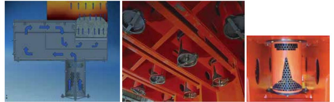
圖 2.4-11 不同型式流量調節設備 (KHD 技術提供)
