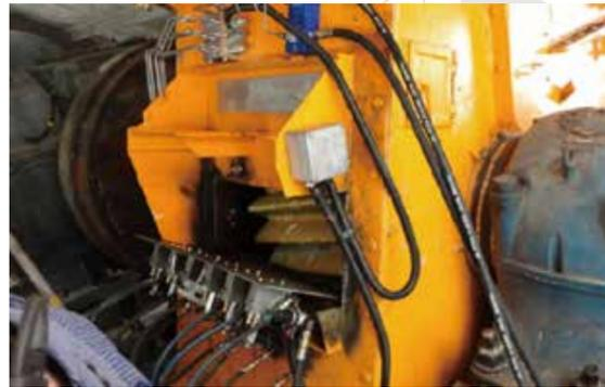
圖 4.2.2-4 窯環齒輪及窯頭止封件更新部分
