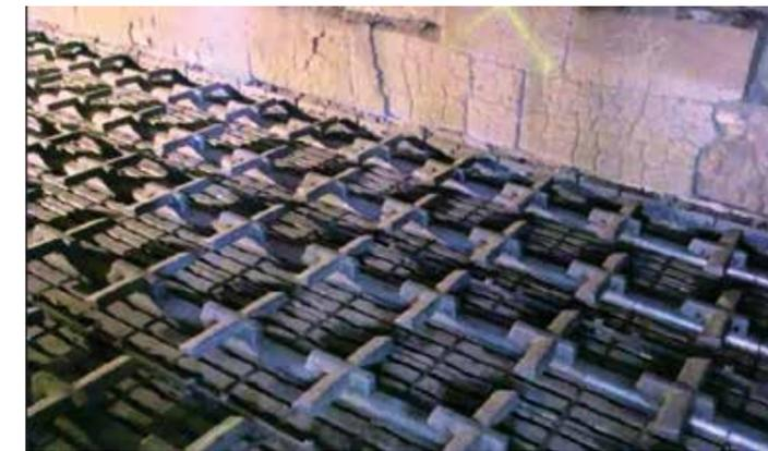
圖 2.4-13 固定式吹氣爐排、推棍式輸送系統 (Polysius 技術提供)
