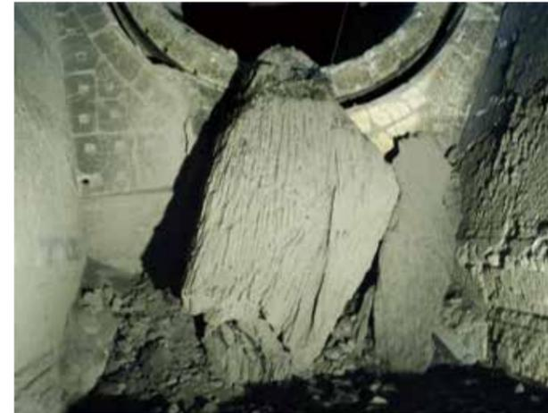
圖 2.4-16 窯落口結料（雪人）示意圖
