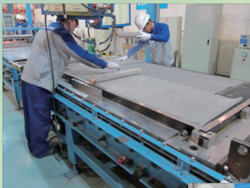
電解槽陰極側彈性體鋪設
