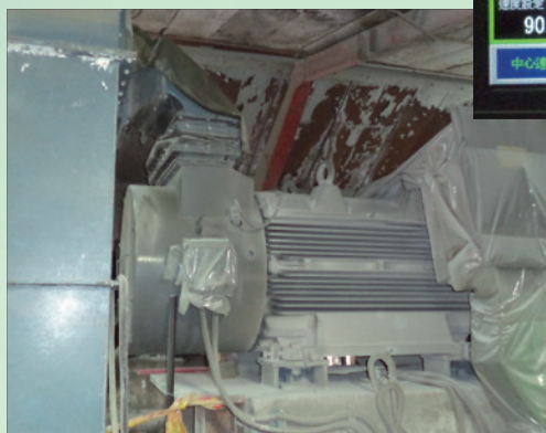
旋窯主馬達，驅動旋窯旋轉
