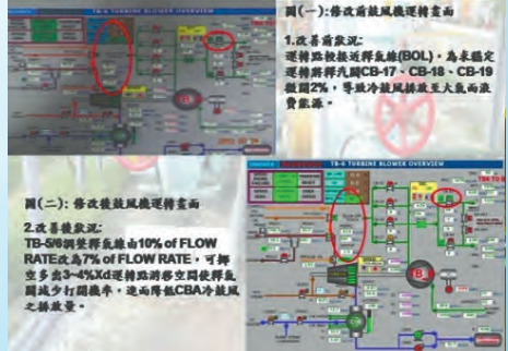
動力二場TB-5/6鼓風機釋氣線調整(製程節能)
