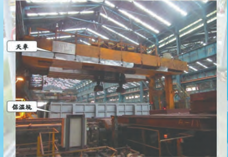
Y411提升熱進爐溫度至460℃(製程節能)
