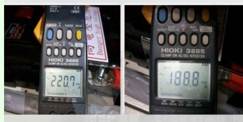
減量措施：冷卻水塔#5冷卻風車設置變頻器，降低用電量。改善效益：節省效益為212仟元/年，可減少83噸之二氧化碳排放。
