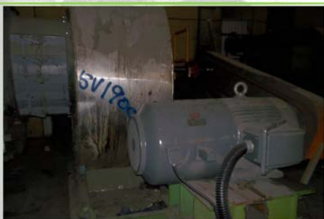
A紙機熱風車馬達220kW改為90kW變頻
