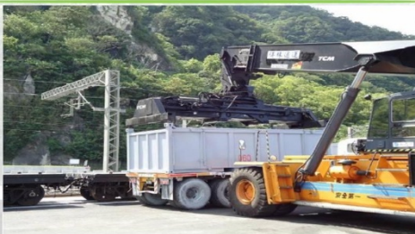
中鋼公司花蓮石料以鐵路運輸取代公路運輸以節省能源耗用 (製程節能)
