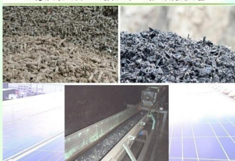
混燒替代燃料(RDF+廢輪胎)，減少煤炭使用量。
