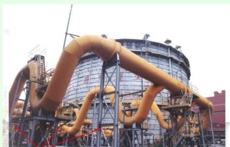
第二煉鋼轉爐氣出口增壓機依轉爐生產狀況來啟動，當轉爐3/3操作時，增壓機由現行2/3運轉改為3/3運轉，並依程式自動調整其輸出流量。
