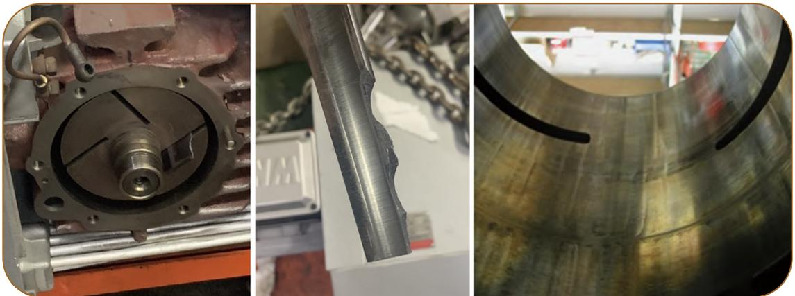
旋片式真空泵因葉片破裂導致真空腔體磨損而無法達到預計真空度
