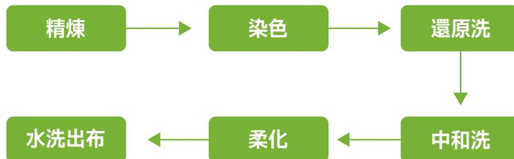
圖4.11.2-2 染色製造流程圖
