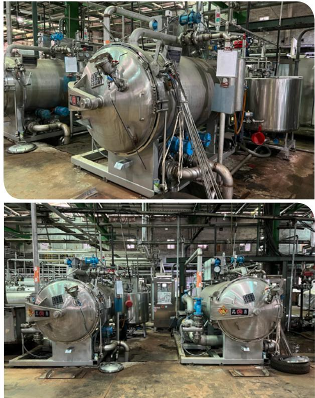
更換後之節能型高溫經軸染色機，染色製程需要依靠蒸汽加熱及排水降溫，主要消耗能源為蒸汽。
