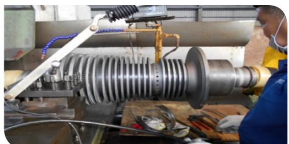
發電效率提升改善重點一更換汽封片：靜葉片鬆動及汽封間隙變大降低發電效率
