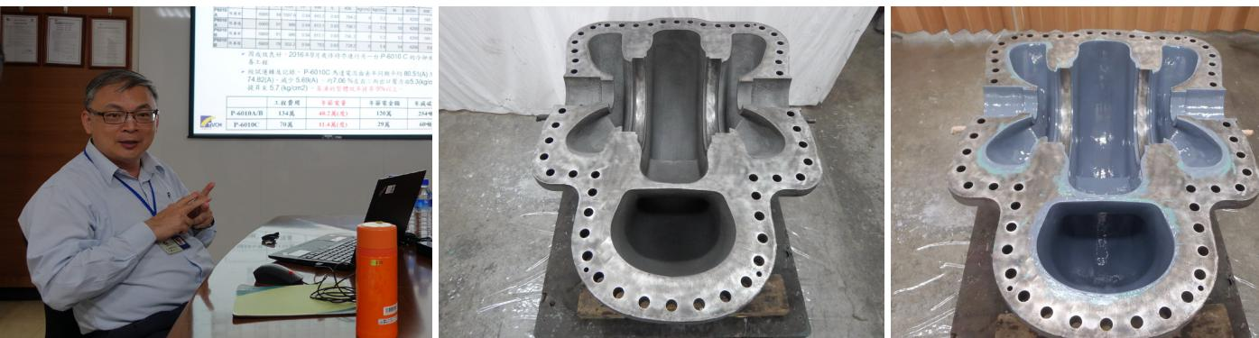
由左至右：鍾副總廠長說明冷卻水循環泵浦的陶瓷複合材防蝕工程、改善前的冷卻水泵浦、改善後的冷卻水泵浦
