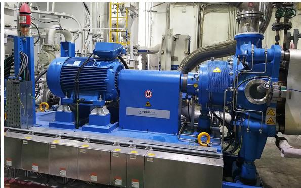
由左至右：PPI B 列製粒機更新改善工程；整合為混鍊、押出一體的製粒機，可有效降低設備運轉能耗。
