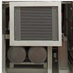
熱交換器及緩衝罐
