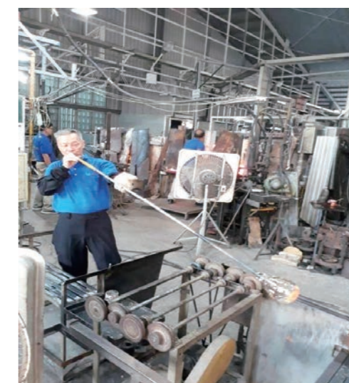
圖 3.2-1 容器玻璃人工吹製
