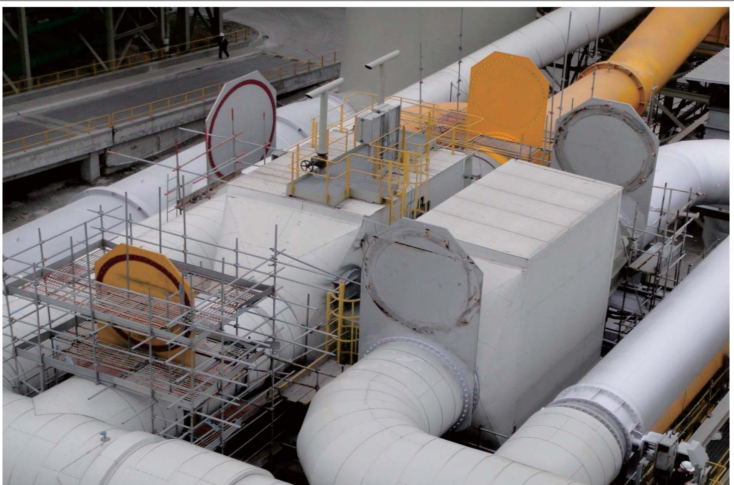
中龍一號及二號熱風爐熱管式應用範例 DSC BF1 & BF2 Heat Pipe Preheater - Ecostat
