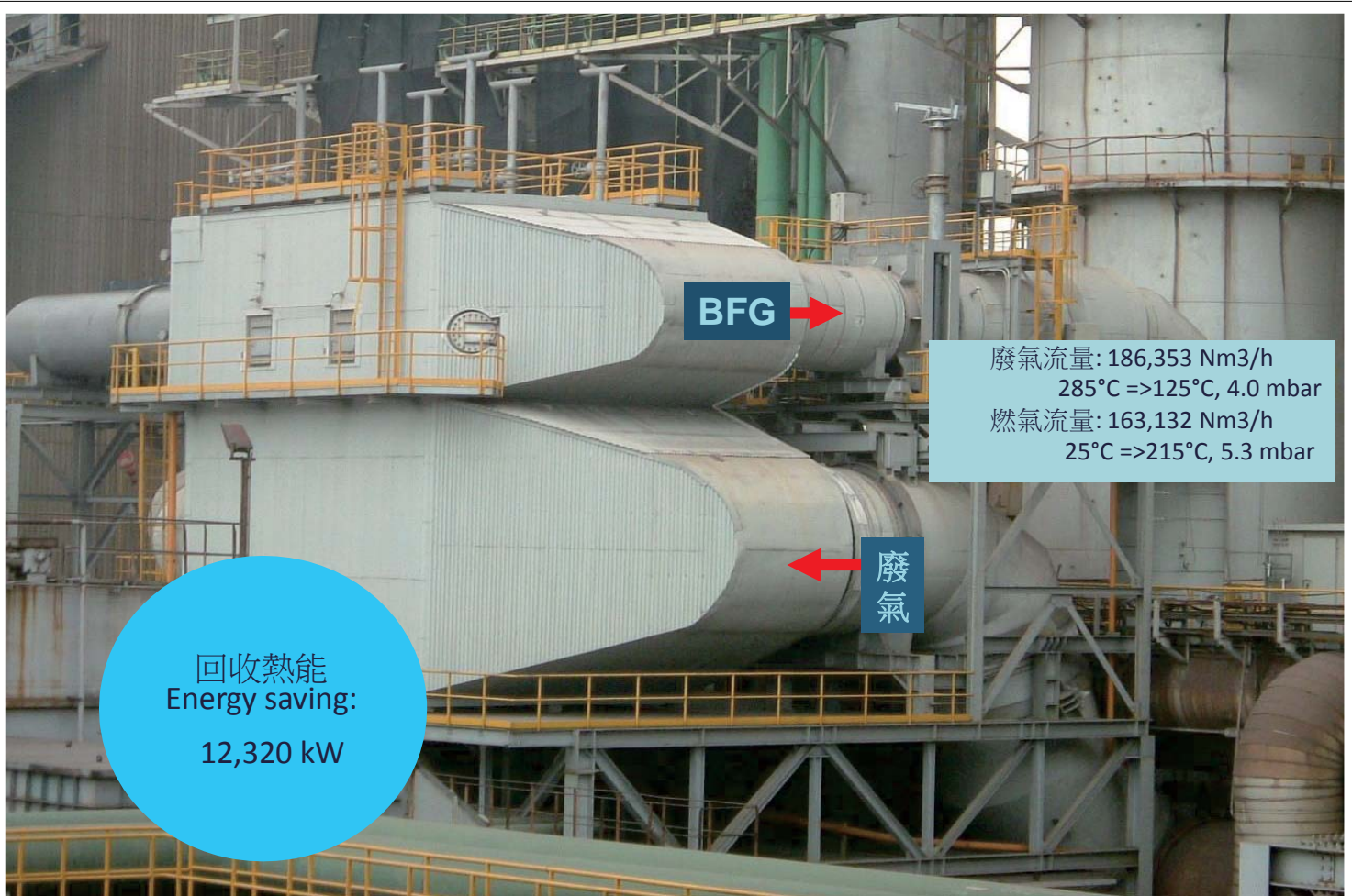
中鋼二號高爐熱管式應用範例 CSC BF2 Heat Pipe BFG Preheater – Ecostat
