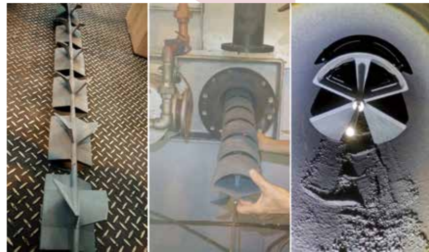
圖 4.3-4 (左) RTI 單體性能測試配置；(右) RTI 實體與安裝照
