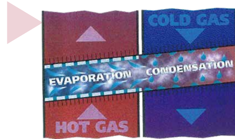
圖 4.1-4 熱管工作原理示意圖
