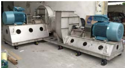
此照片為本公司在長春石化廠所設計的串連風機方式
