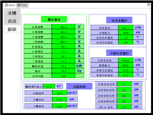
冰水效能監視 管理系統
