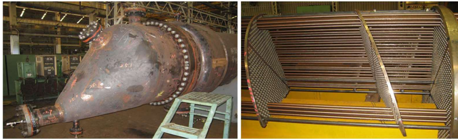
台化某廠 - 槽頂冷卻器
