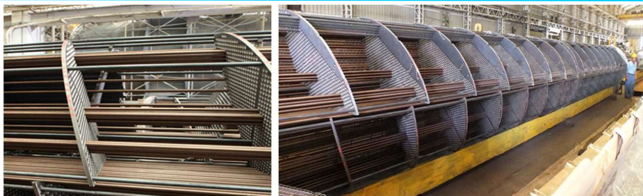
台塑某廠 - 塔頂冷凝器
