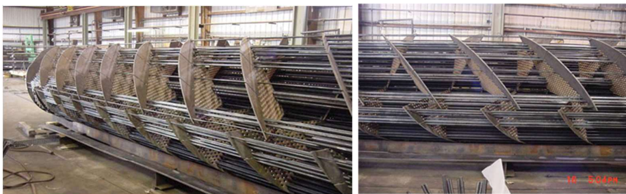
美國某廠 - 壓縮機後冷卻器 After Cooler
