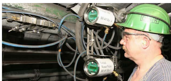
採煤 (高壓水) 壓力 300 – 400 Bar
