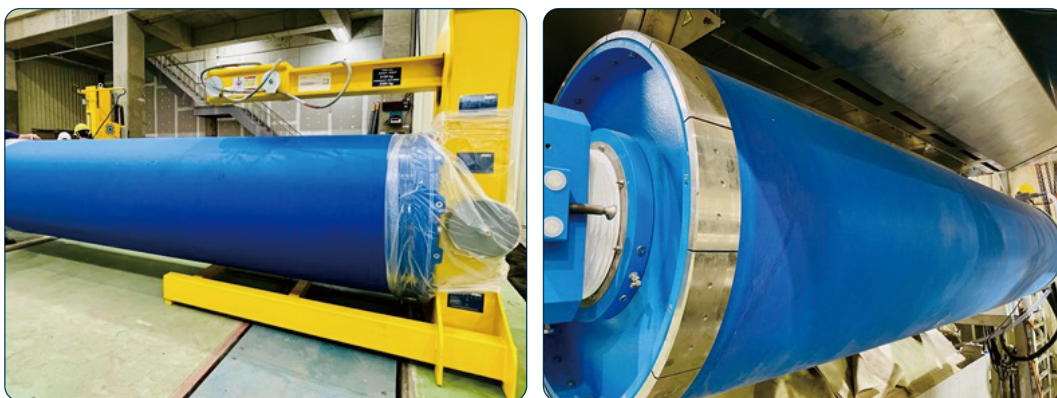
圖3.2.5-1 靴式壓榨輥照片
