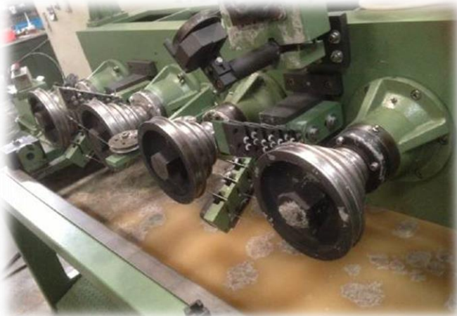
伸線機(同步轉速_張力控制)
