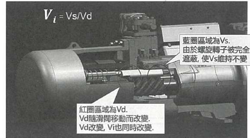
圖4. 螺旋式壓縮以滑閥控制容積比( V_i )的作動原理
