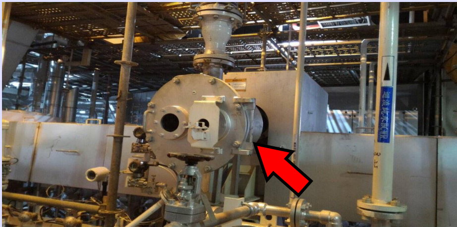
增設抽真空系統降低膠粒中揮發份
