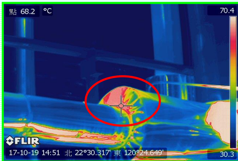
蒸汽管線設備紅外線熱影像檢測
