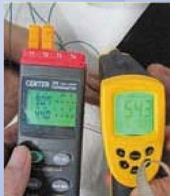
噴塗後染色機內部溫度為 90.7°C，表面溫度下降至44°C。
